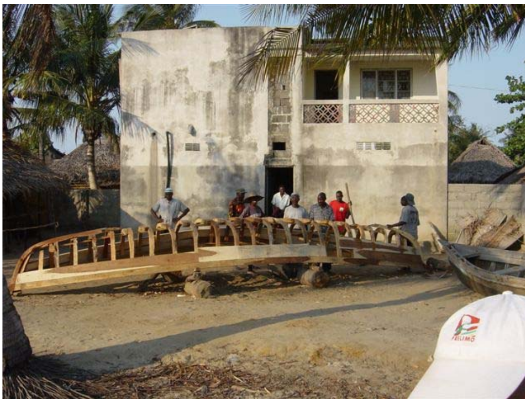
Figura 5: Construção de uma lancha em Angoche (Foto Camila de Sousa)
