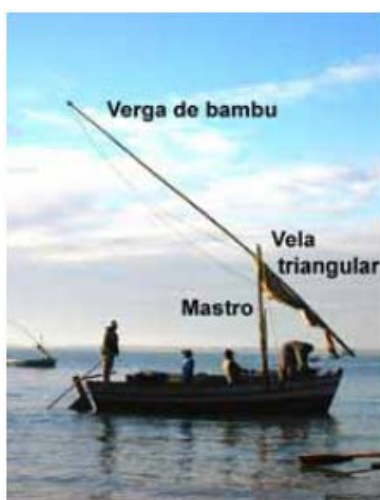
Figura 7: Esquema de uma lancha (Adaptado de Santos, 2004)
